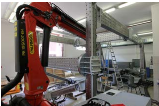
Реконфигурируемый стенд для испытаний строительных конструкций (1500 кН)
