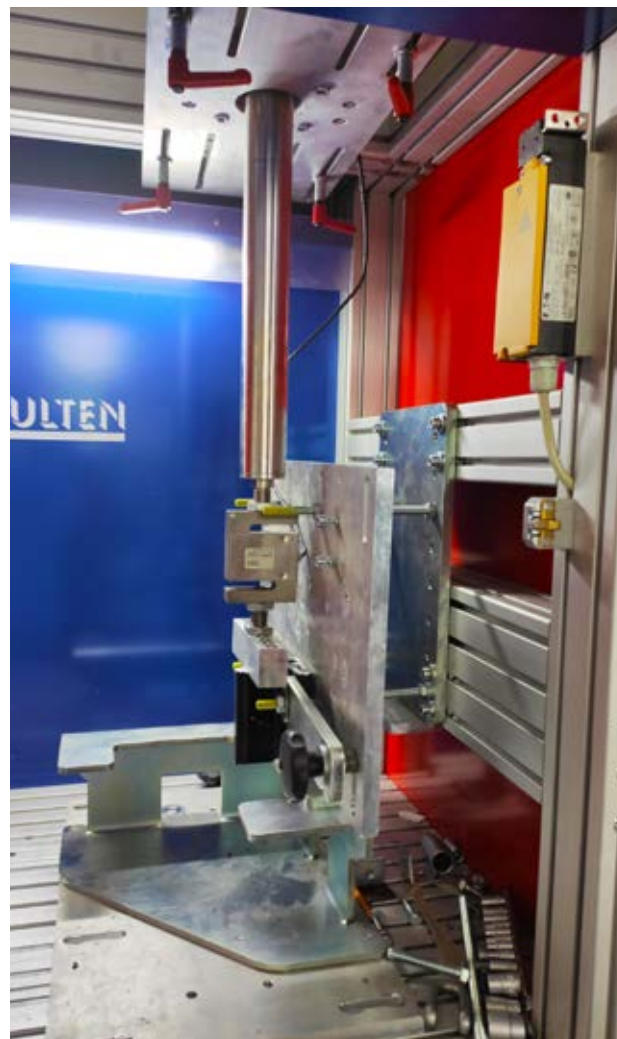
Стенд для испытания угловых соединений
