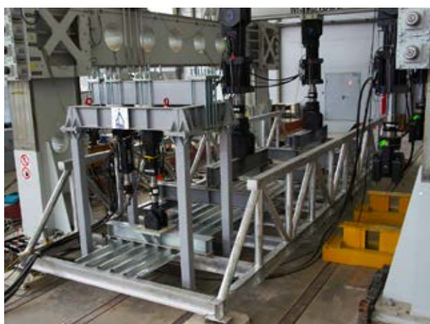
Испытания мостовых конструкций из алюминиевых сплавов
