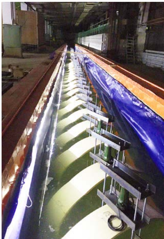
Проведение долгосрочных испытаний образцов стеклокомпозитных труб в соответствии с ГОСТ Р ИСО 10467-2013
