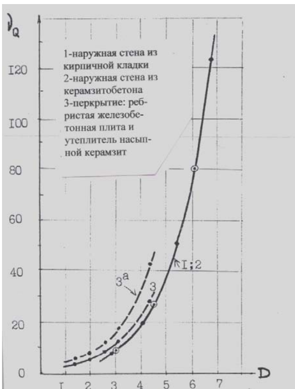
Рис.5.1. Коэффициент затухания тепловых потоков в массивных ограждениях
