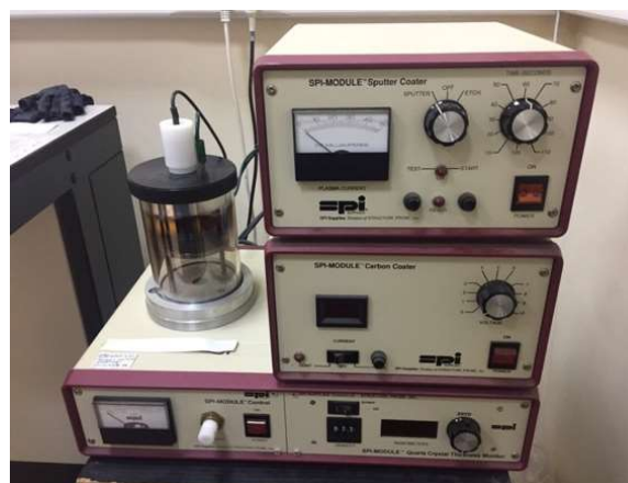
Рисунок 2.6 — Вакуумная напылительная установка SPI-MODULE
