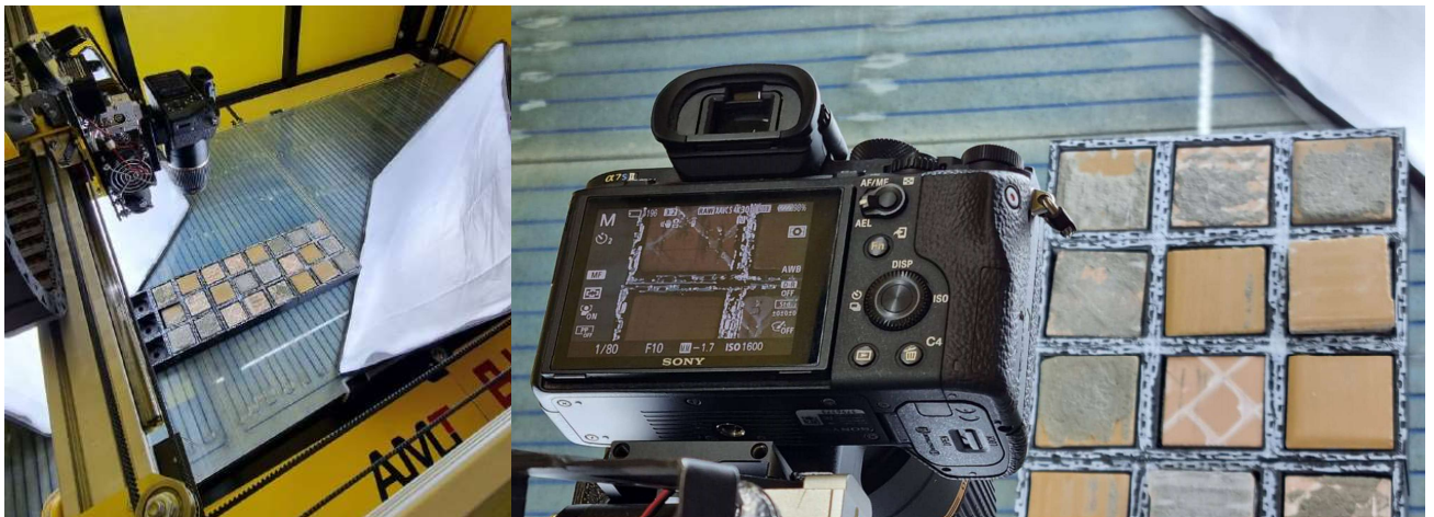
Рисунок 2.7 — Фотограмметрический метод оценки различных характеров разрушения образцов после испытания прочности сцепления
