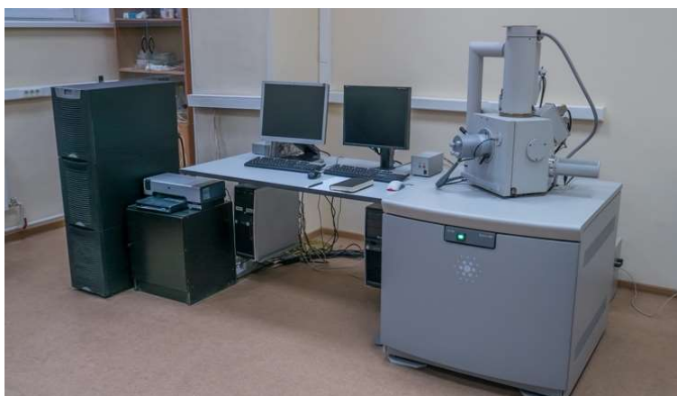
Рисунок 2.5 — Растровый электронный сканирующий микроскоп Quanta 200 FP с приставкой энергодисперсионного химического микроанализа
