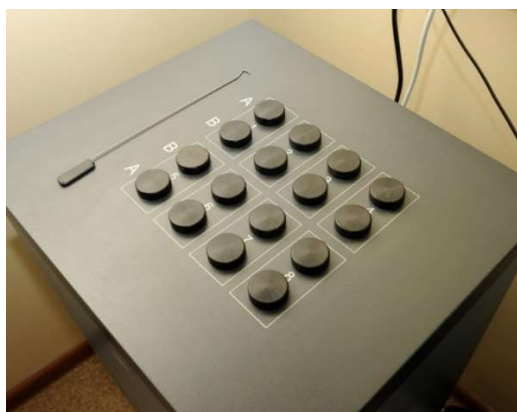
Рисунок 2.10 — Изотермический калориметр TAM Air
