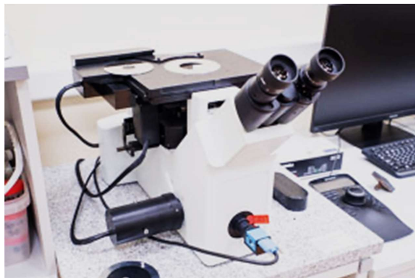
Рисунок 2.9 — Моторизованный оптический инвертированный микроскоп OLYMPUS GX53
