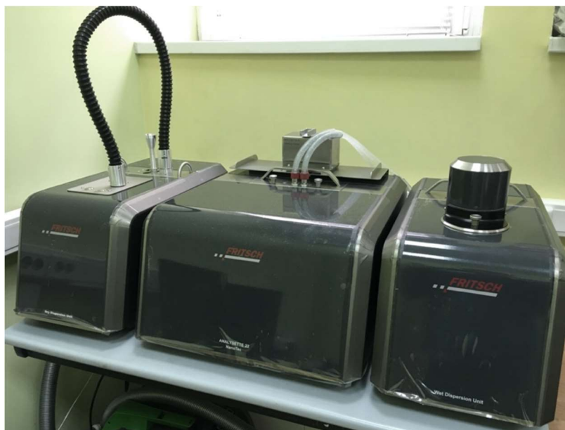
Рисунок 2.1 — Лазерный анализатор размеров частиц Fritsch Analysette 22 NanoTec
