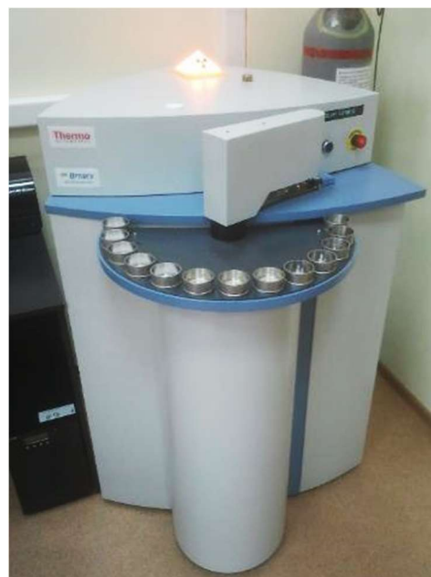
Рисунок 2.3 — Рентгенофлуоресцентный волнодисперсионный спектрометр ARL Optim`X 200W
