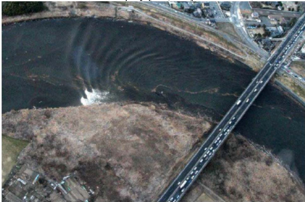
Рисунок 3.5 – Волна цунами в Японии, 2011 год. Волны идут против течения на реке Нака, пример волнообразного бора (идет справа налево) [143, 145]
