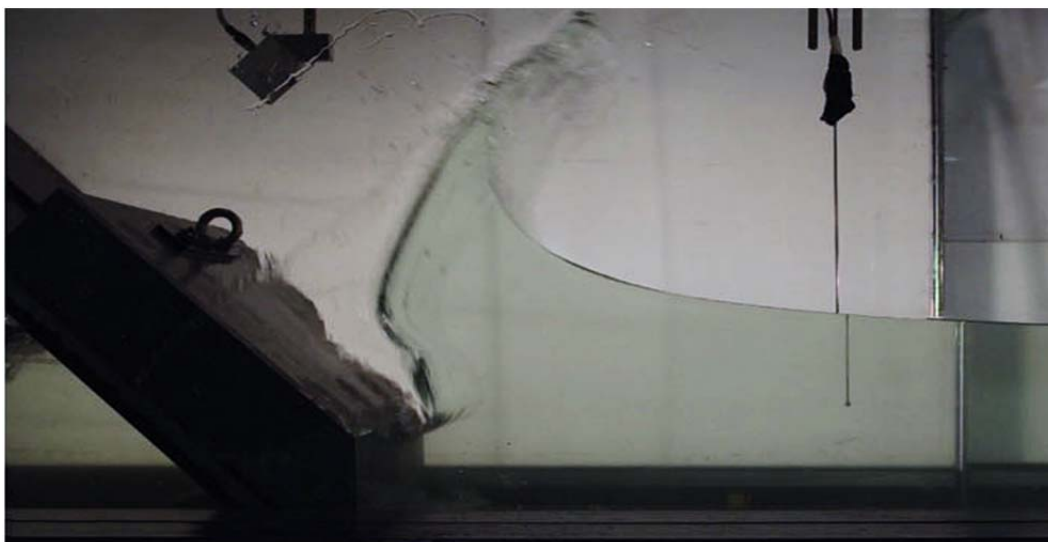
Рисунок 3.19 – Моделирование оползневого цунами методом твердого блока в Имперском колледже Лондона (адаптировано из [87])
