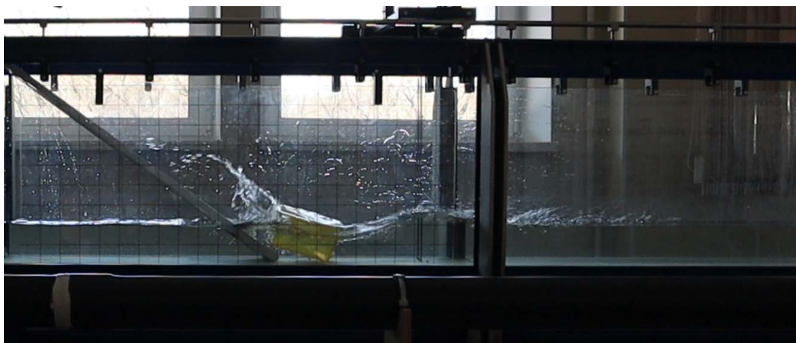
Рисунок 3.21 – Проведение эксперимента по моделированию оползневых цунами в июне 2022 года
