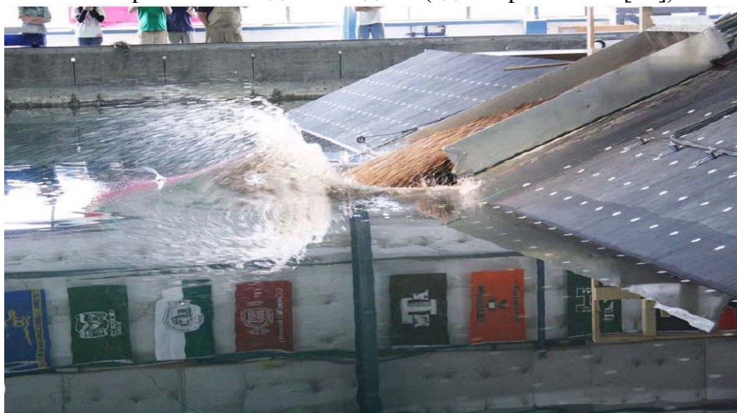
Рисунок 3.20 – Использование грунта для создания одиночной волны в Орегонском государственном университете (адаптировано из [90])
