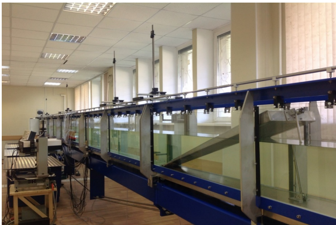
Рисунок 2.13 – Гидравлический лоток для проведения опытов в НИУ МГСУ [83]
