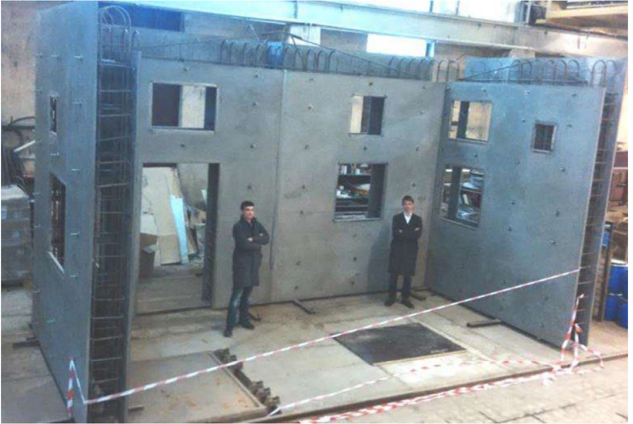
Рисунок 1.2. Опытные образцы армоблоков со сталефибробетонной опалубкой.
