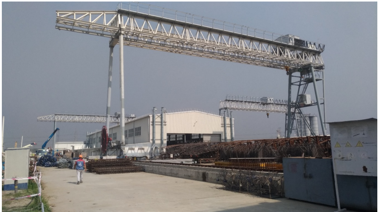
Рисунок 1.6. Открытая площадка сборки армоблоков (АЭС «Руппур», Народная Республика Бангладеш).
