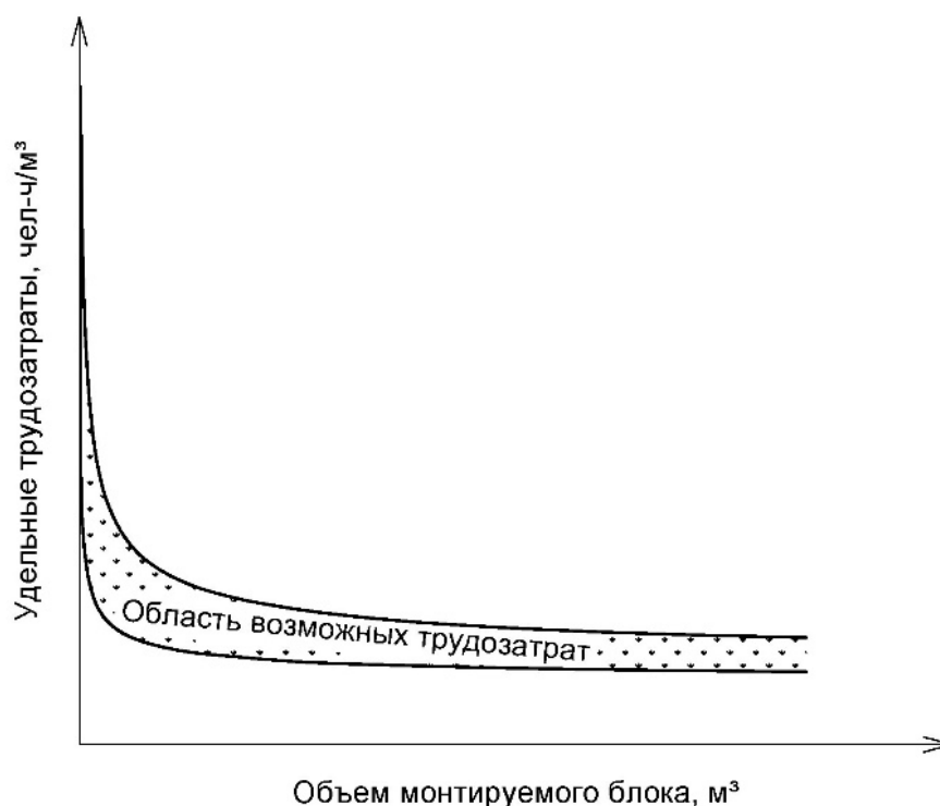
Рисунок 3.8. Зависимость трудозатрат на монтаж армоблока в зависимости от объема армоблока.
